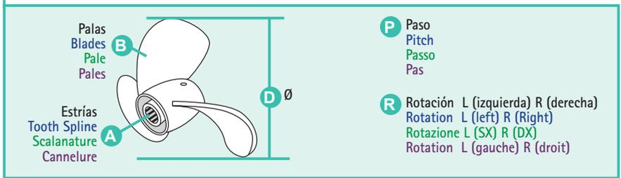
NÚCLEO INTERCAMBIABLE INTERCHANGEABLE HUB
