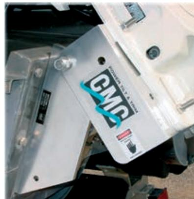
Soporte con kit de Power Trim y Tilt. Fabricado en extrusión de aluminio con tornillos de acero inox. El motor electro-hidráulico de 3500 kg de empuje se encuentra dentro de un contenedor para una mayor protección.
