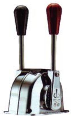
Palanca con doble función (acelerador y cambio). Para 1 ó 2 motores. Carcasa cromada de fundición. Interruptor de protección de arranque en punto muerto. Aceleración en punto muerto por desplazamiento exterior de la palanca. Utiliza 2 ó 4 cables 33-C y 3300C.
