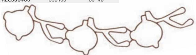
**JUNTAS DE ADMISION ESTRIBOR A CARBURADOR**    **STB INTAKE TO CARBURATOR GASKETS**    **GUARNIZIONI ASPIRAZIONE DISTRA - CARBURATORE**    **JOINT DU CARTER D'ADMISSION DROIT AU CARBURATEUR**
