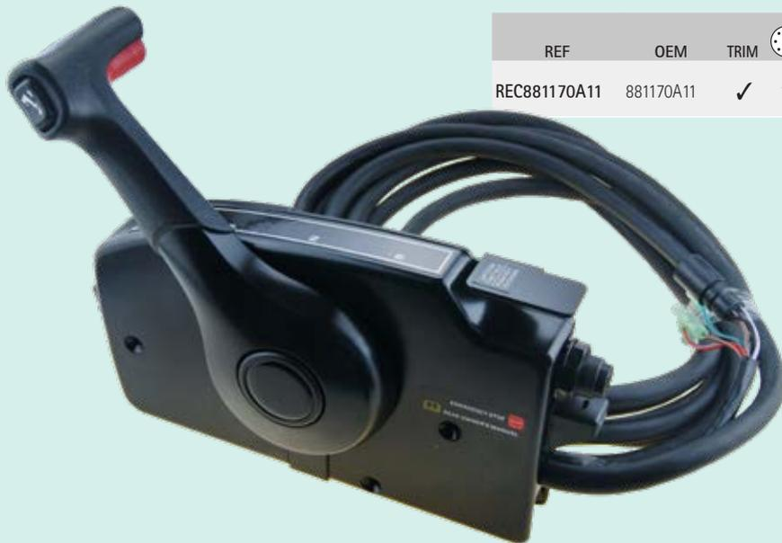
Tiene un arnés con conector Amp y se conecta directamente sin el uso de un arnés adaptador.
